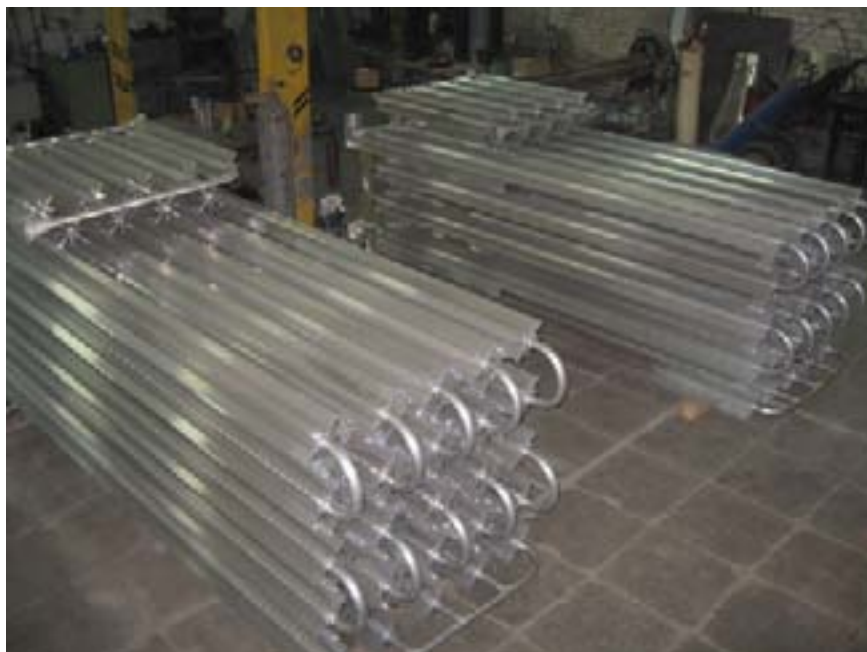
Рис. 13. Производственные испарители ИА-190/4 с навесными испарителями наддува
