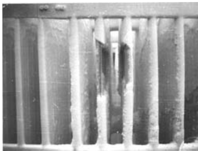
Рис. 3. Обмерзание холодной секции
