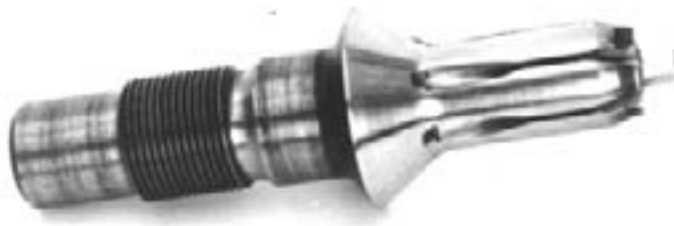
Рис. 6. Элемент оснастки. Игла для формирования внутренних ребер (6 шт.) труб с продольным оребрением методом экструзии.
